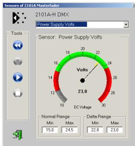
Das Gerät verfügt über drei Sensoren, die über DMX RDM ausgelesen werden können.
